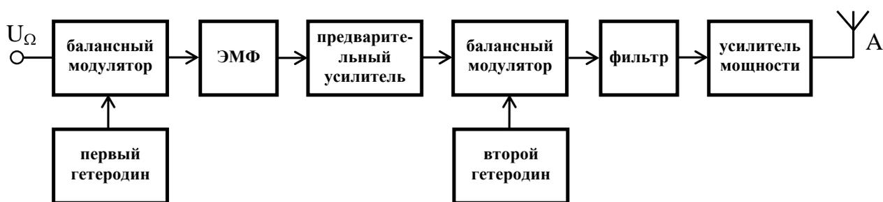
Рис. 2. Структурная схема передатчика с однополосной модуляцией
