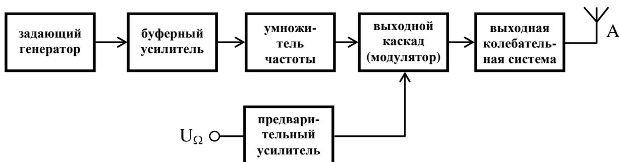
Рис. 1. Структурная схема передатчика с амплитудной модуляцией
